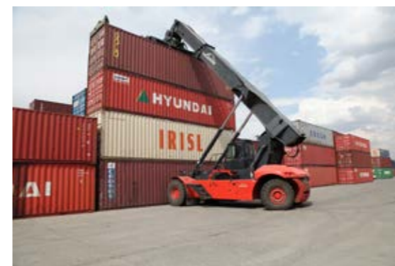
نمایی از کارکرد دستگاه ریج استکر در حال جابه‌جایی کانتینر در محوطه شرکت تهران (غرب)
