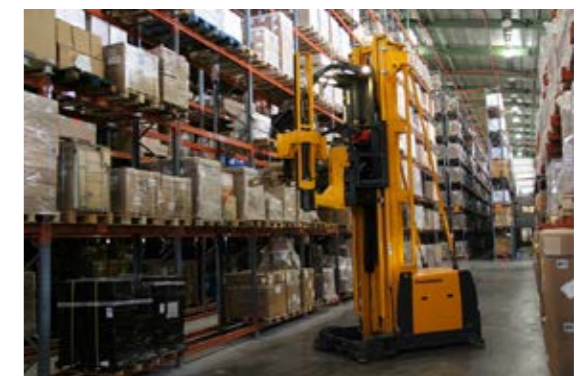
نمایی از کارکرد دستگاه بالابر با ارتفاع ۱۰ متر برای طبقه‌بندی کالاها در قفسه‌های انبارهای فرودگاه بین‌المللی امام خمینی ره
